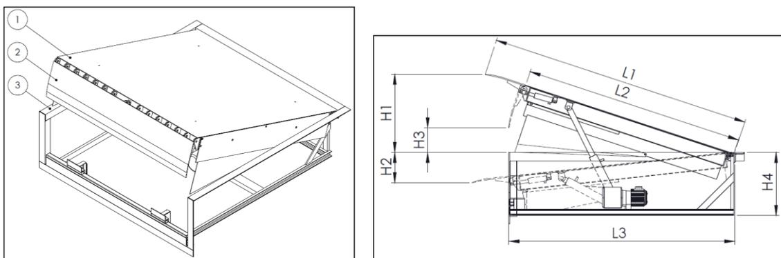
Tanto la plataforma como el labio están fabricados en lámina lagrimada sin uniones. La elasticidad natural de la estructura permite absorber una inclinación lateral de 100mm.
